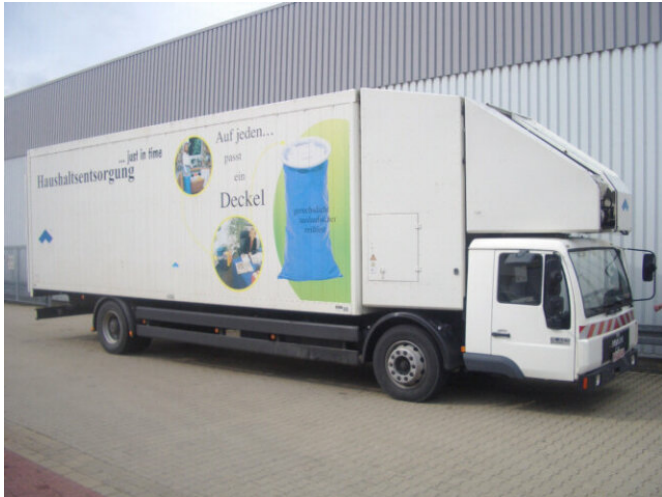
MAN L89 18.224 4x2 L89 18.224 4x2 mit Schubboden und Förderband, ca, 51 cbm
