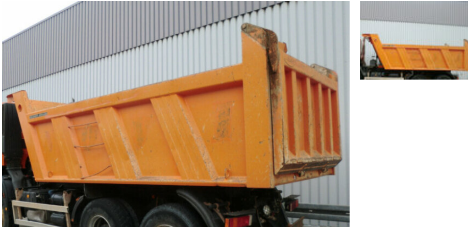
Meiller 3-Achs Kippmulde Meiller Stahlmulde, Jet Design 14 cbm
