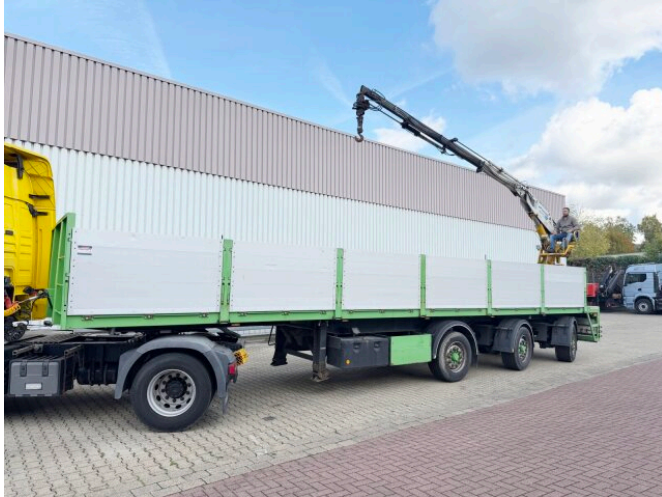
KWB Baustoff-Auflieger mit Rollkran Kennis 14R Baustoff-Auflieger, Rollkran Kennis 14R, Liftachse, 2x Lenkachse
