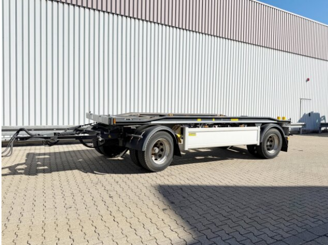
Hüffermann HAR 20.58 HAR 20.58, Abrollanhänger, Deichsel absenkbar
