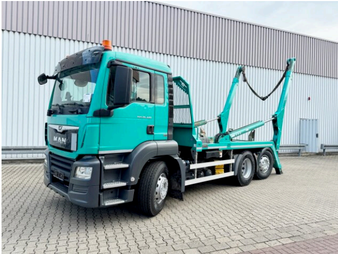
MAN TGS 26.420 6X2-4 BL TGS 26.420/470 6X2-4 BL, Lenk-/Liftachse, Motorabtrieb, Tele-Absetzer, Funk
