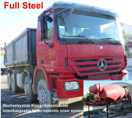
Mercedes-Benz Actros 3241 B 8x4/4 Actros 3241 B 8x4/4, Wechselsystem Kipper/Betonmischer, 2x Nebenantrieb
