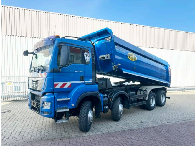
MAN TGS 41.460 8x8 BB TGS 41.460 8x8 BB, Meiller Stahlmulde ca. 20m 3
