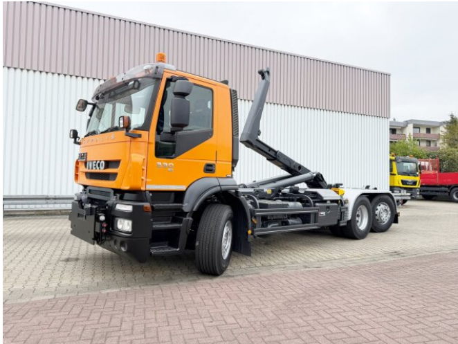
Iveco Stralis AD260S33Y/PS 6x2 Stralis AD260S33 6x2, Winterdienstausstattung, Lenk-/Liftachse, Motorabtrieb
