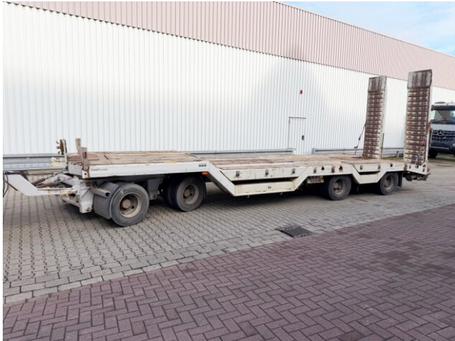
ZANDTCARGO AT 400 AT 400, Verbr. auf 3m, Radmulden, hydr. Rampen
