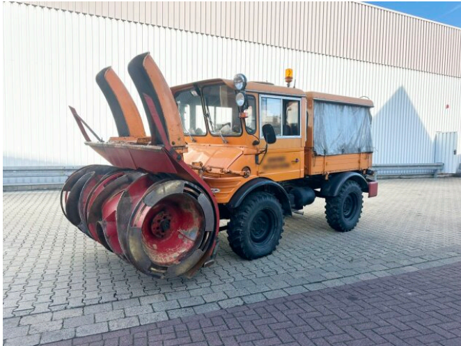
Unimog U52 411 4x4 Schneefräse U52 411 4x4, Schmidt Schneefräse mit Separatmotor
