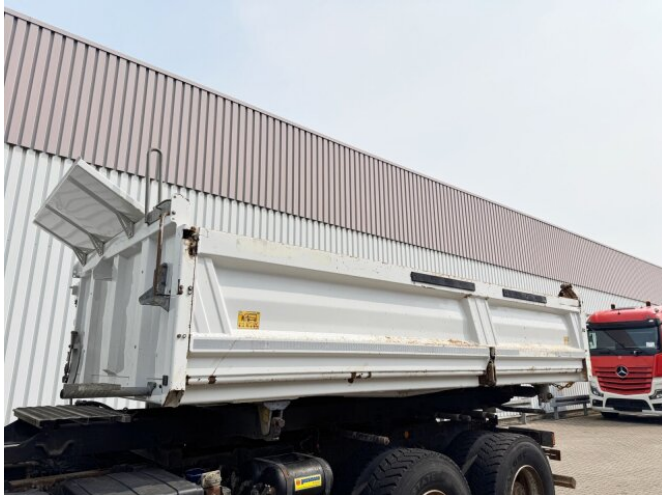
Meiller 3-Seiten-Kippaufbau mit Bordmatik 3-Seiten-Kippaufbau mit Bordmatik ca. 9,5m³
