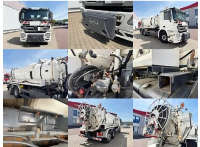
Mercedes-Benz Actros 2541 L 6x2 Actros 2541 L 6x2, Müller Saug-/Spülwagen ca. 12m 3 , Widi-Platte, Lift-/Lenkachse
