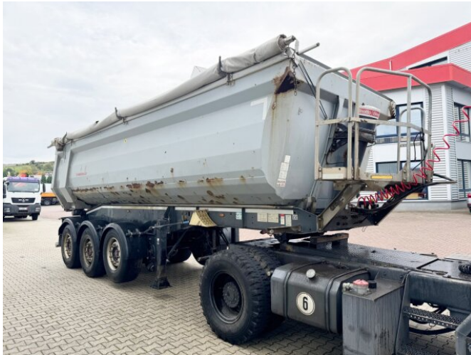
Schwarz Müller K-Serie Kippauflieger K-Serie Kippauflieger, Stahlmulde ca. 27m³, Liftachse
