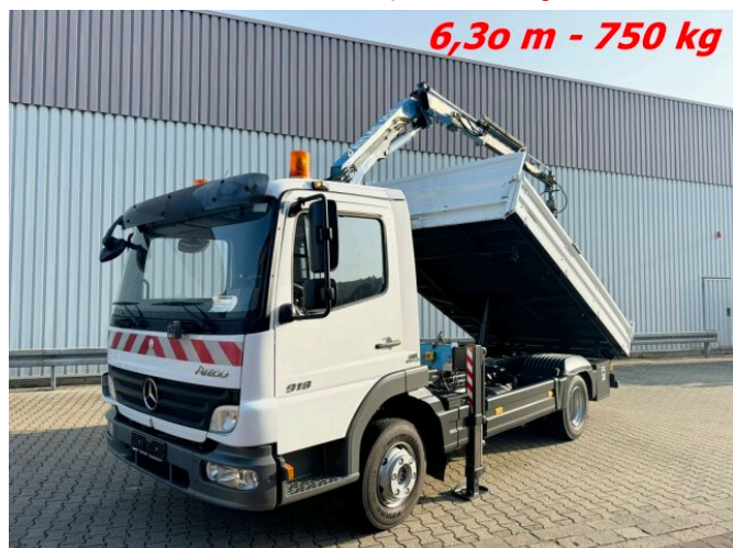
Mercedes-Benz Atego 818 K 4x2 Atego 818 K 4x2 mit Kran Atlas AK 50.1-A2
