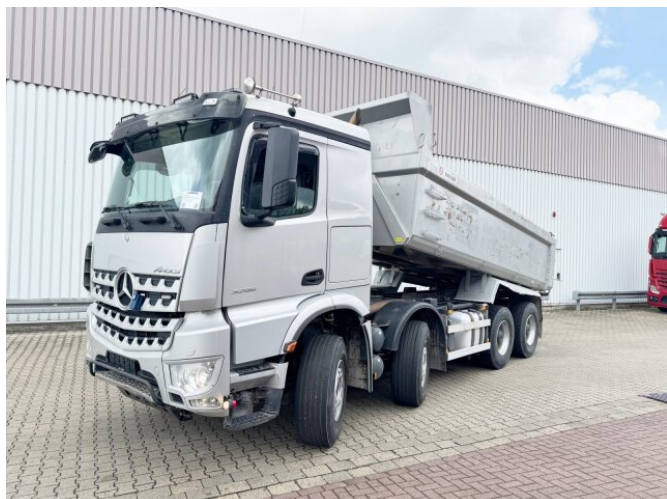
Mercedes-Benz Arocs 3258 LK 8x4/4 Arocs 3258 LK 8x4/4, Retarder, Bi-Xenon, Stahlmulde ca. 14m 3 , hydr. Heckklappenöffnung
