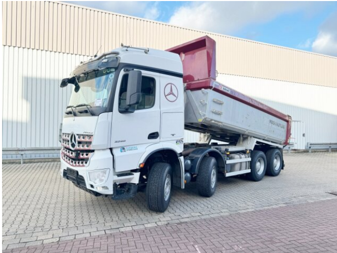
Mercedes-Benz Arocs 3258 LK 8x4/4 Arocs 3258 LK 8x4/4, Retarder, Stahlmulde ca. 14m 3 , hydr. Heckklappenöffnung
