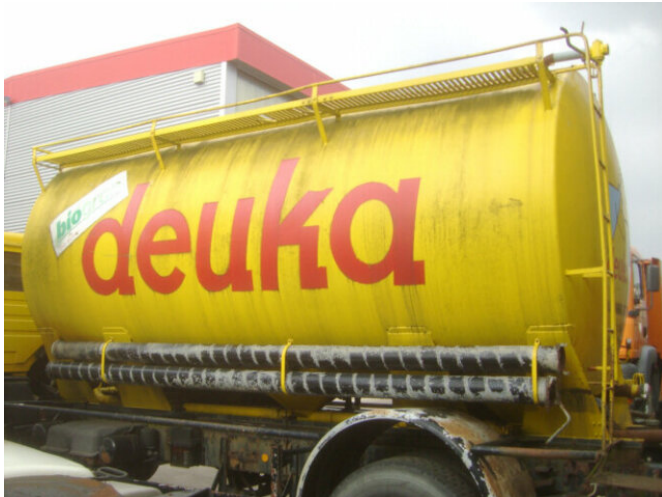
Welgro Silo - Welgron Siloaufbau, 18 cbm
