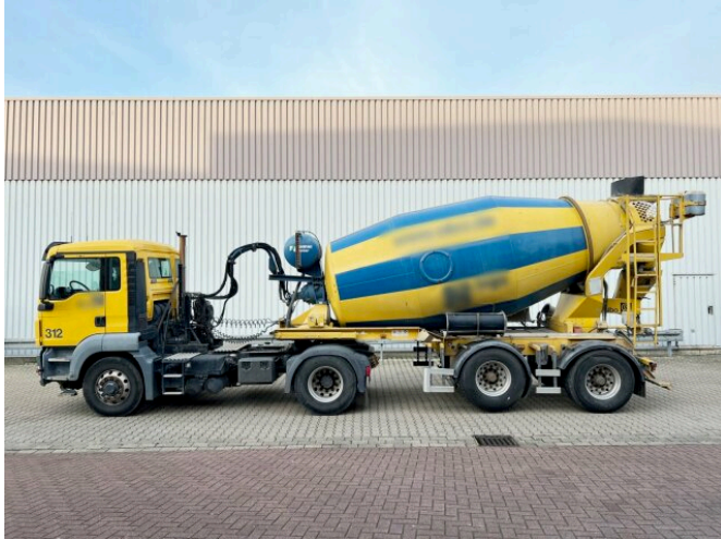
MAN TGS 18.440 4X4H BLS TGS 18.440 4X4H BLS, STETTER AM10FHAC Mischer ca. 10m 3
