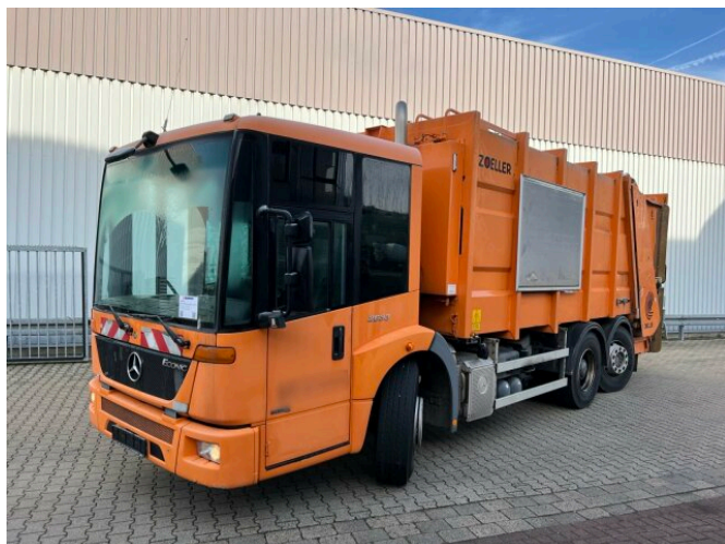
Mercedes-Benz Econic 2633 L 6x2/4 NLA Econic 2633 L 6x2/4 NLA, Lenkachse, Zöller Medium XL, Zöller-Schüttung
