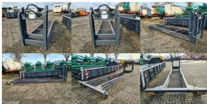
**GASSMANN Abrollrahmen 5500mm ohne Containerverriegelung**
