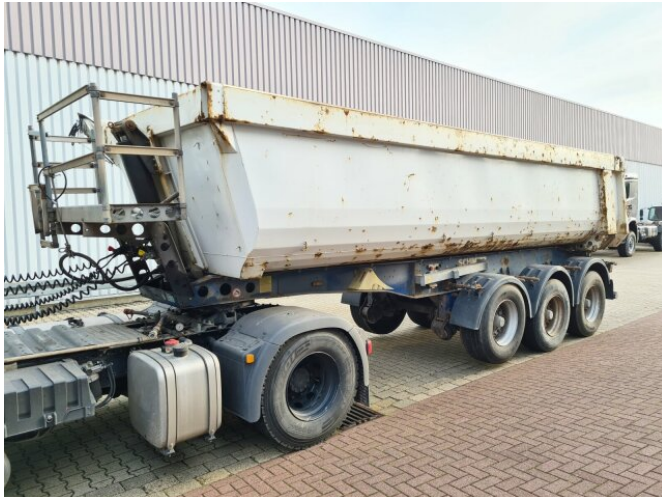
Schmitz SKI 24 SL 7.2 SKI 24 SL 7.2, Stahl ca. 24m 3 , 20x VORHANDEN, Liftachse
