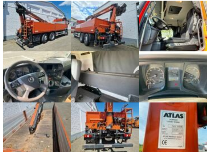
Mercedes-Benz Arocs 2545 L/6x2/4 Arocs 2545 L/6x2/4, Atlas Kran, 145.2-A19 VB, 9,4m-1.51 to, Lenkachse, entlastbar, Retarder, Klima,
