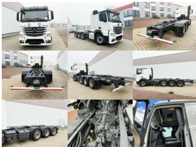
**Mercedes-Benz Actros 3551 L 8x2/4, Vorlaufenkachse, Doppelbereifte Nachlauflichtachse**
