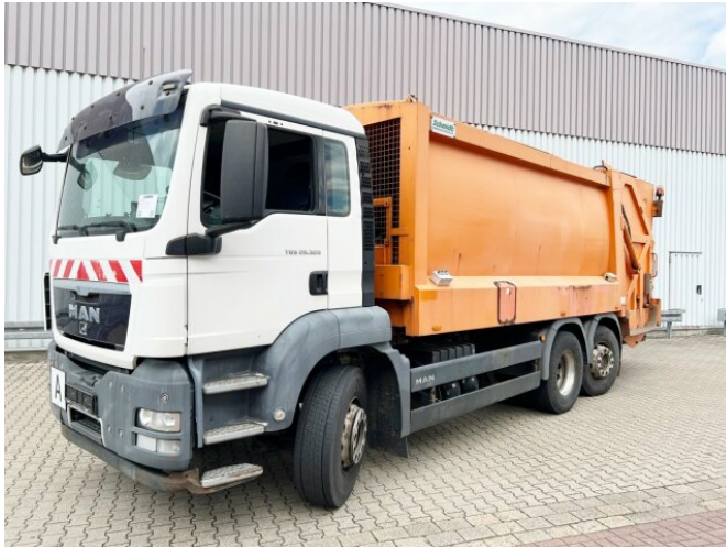
MAN TGS 26.320 6x2-4 BL TGS 26.320/400 6x2-4 BL, Lift-/Lenkachse, Heil PLK 21 M, Zöller-Schüttung
