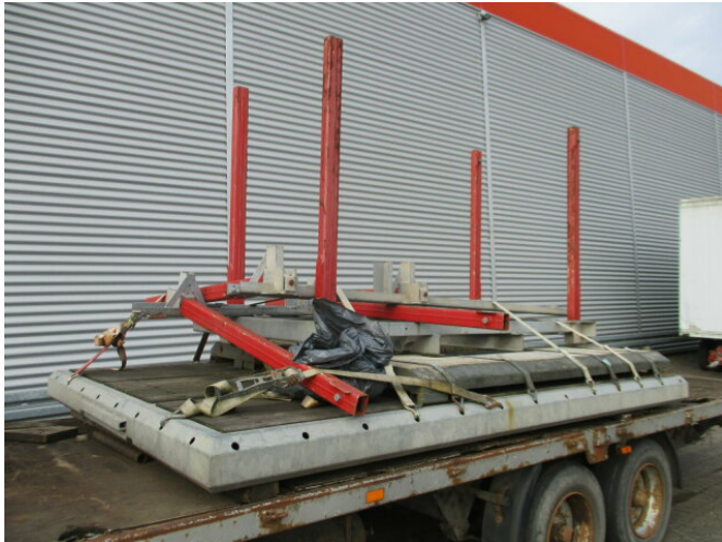
- Pritschenaufbau mit Wechselsystem Pritschenaufbau mit Wechselsystem für Sattelkupplung mit Böcke
