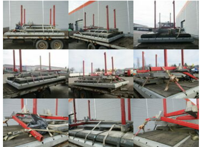
- Pritschenaufbau mit Wechselsystem Pritschenaufbau mit Wechselsystem für Sattelkupplung mit Böcke
