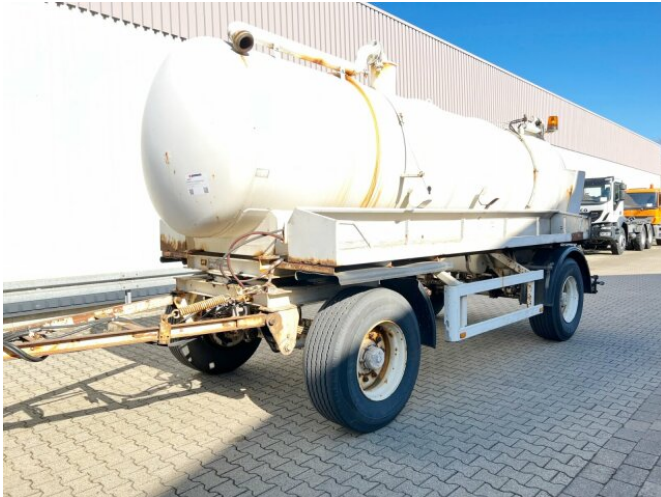
Kramer SA 18 Fäkalienanhänger Kramer, SA 18 Fäkalienanhänger, ca. 10.000l
