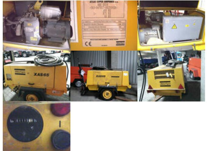
Atlas GA-XAS 65E ATLAS COPCO GA-XAS 65E, Kompressor 5m<sup>3</sup>/min, E-Antrieb
