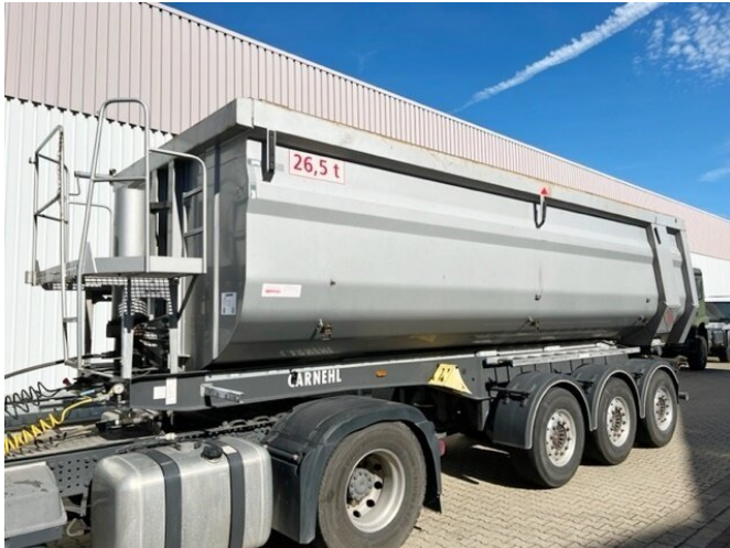
Carnehl CHKS34/HS CHKS34/HS, Stahlmulde ca. 29m³, HARDOX, Liftachse, Schütte
