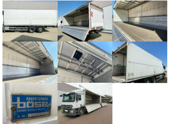
Boese Getränkekoffer Getränkekoffer mit Schwenkbordwänden, Ladegutsicherung
