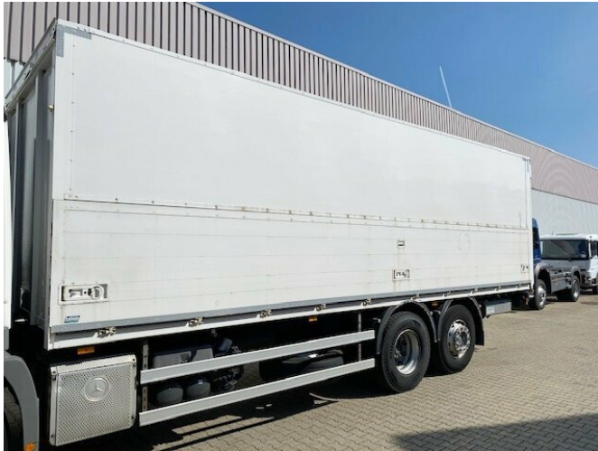
Boese Getränkekoffer Getränkekoffer mit Schwenkbordwänden, Ladegutsicherung
