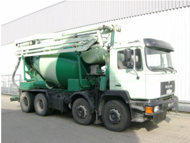
MAN 33.292 8x4 33.292 8x4 Mischer Stetter 7m³ mit Pumpe Schwing 21m, 6-Zylinder
