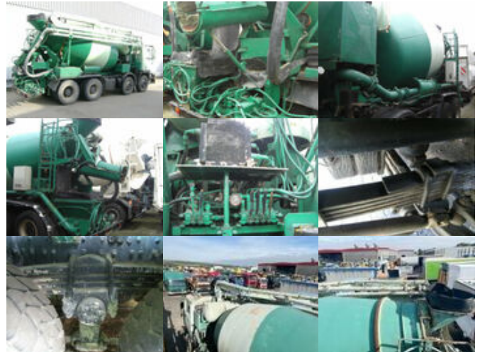
MAN 33.292 8x4 33.292 8x4 Mischer Stetter 7m 3 mit Pumpe Schwing 21m, 6-Zylinder
