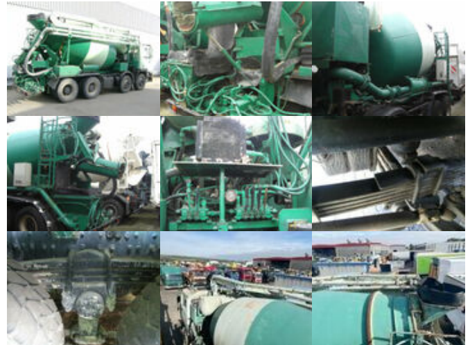
MAN 33.292 8x4 33.292 8x4 Mischer Stetter 7m³ mit Pumpe Schwing 21m, 6-Zylinder
