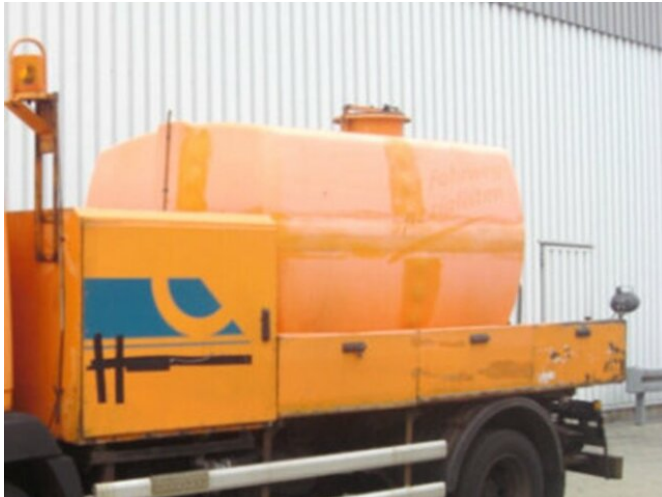
Sonstige Hersteller DA22, 5.000 ltr. Tank mit Pumpe Spülaufbau DA22, 5.000 ltr. Tank mit Pumpe
