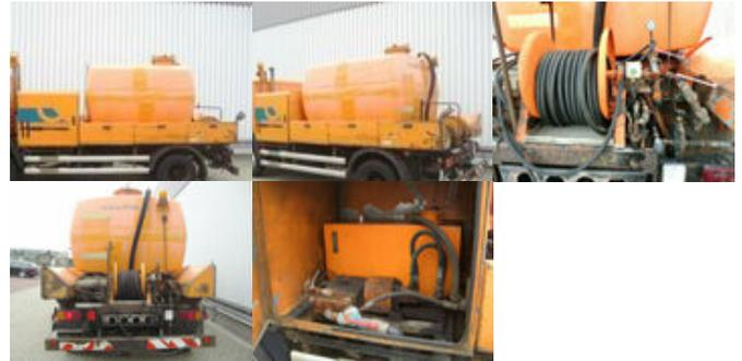
Sonstige Hersteller DA22, 5.000 ltr. Tank mit Pumpe Spülaufbau DA22, 5.000 ltr. Tank mit Pumpe
