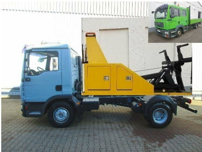
MAN TGL 8.180 4x2 BB TGL 8.180 4x2 BB, Falcom Hubbrille FAW 3000, teleskopierbar
