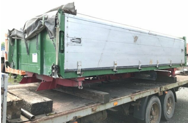
KUMLIN MK 18/3 MK 18/3 3-Seiten-Kippaufbau mit Alu-Bordwänden
