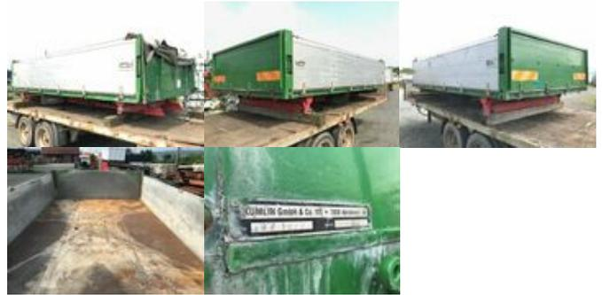
**KUMLIN MK 18/3 MK 18/3 3-Seiten-Kippaufbau mit Alu-Bordwänden**
