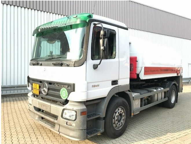
Mercedes-Benz Actros 1841 L 4x2 Actros 1841 L 4x2, Esterer Tankaufbau ca. 13.500l, 2 Kammern
