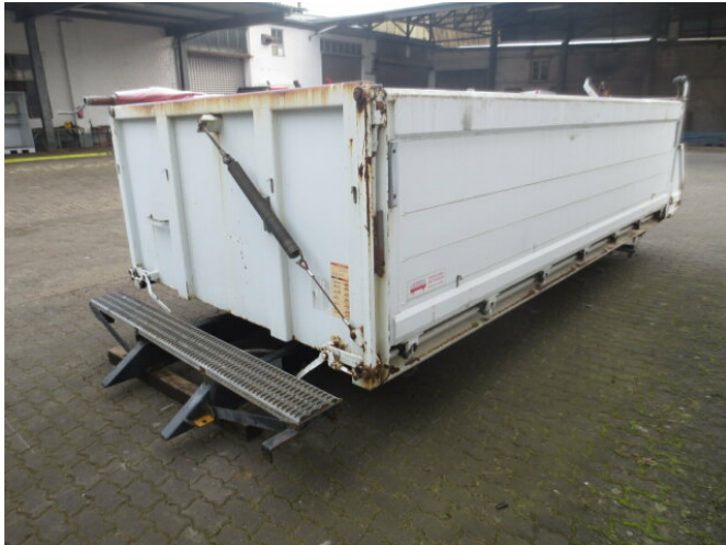
Carnehl 3-S-Kippbrücke, Alu Pendelbordwände und abklappbar, 13 cbm
