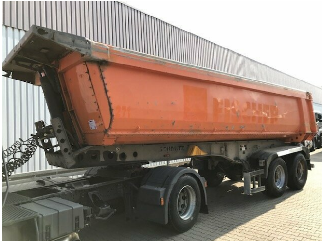
Schmitz SKI 18 SL06-7.2 SKI 18 SL06-7.2 Alumulde mit Stahlboden ca. 25m 3
