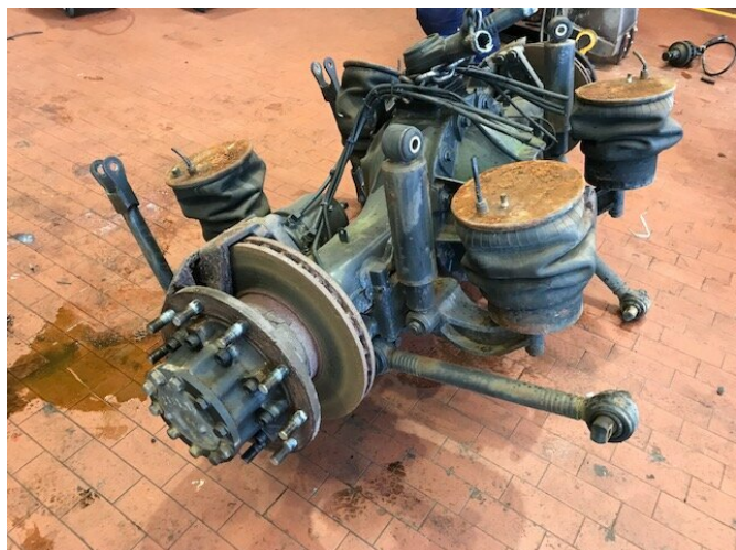
MAN TGA Hinterachse HY-1350-03 TGA Hinterachse HY-1350-03
