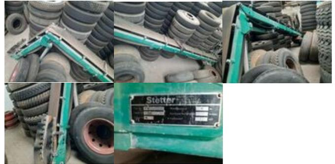
**Stetter F 12 F 12, Förderband für Betonmischer**
