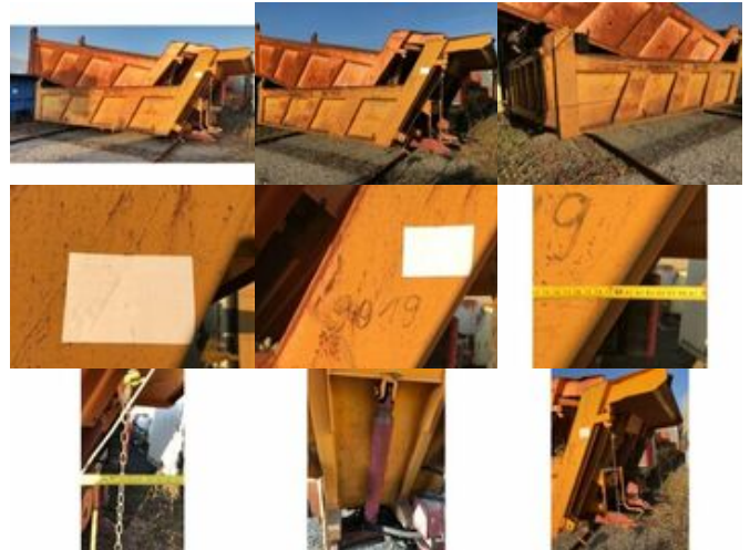
Meiller Mulde ca. 12,5m 3 Meiller Mulde, Jet Design ca. 12,5 cbm, Heckklappe, Dachschutz
