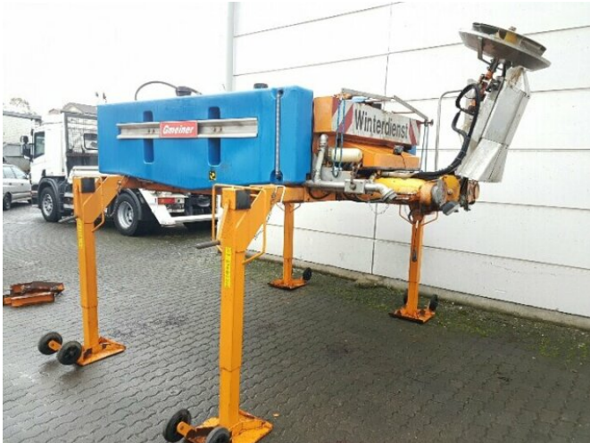
GMEINER STA 1800 TC Gmeiner Streuautomat STA 1800 TC mit Hydraulikantrieb
