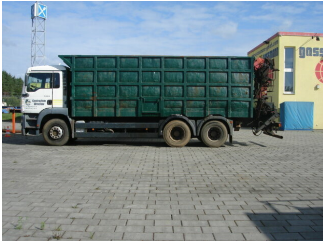
MAN TGA 26.413 BB 6x4 TGA 26.413 BB 6x4 mit Heckkran Jonsered 1020
